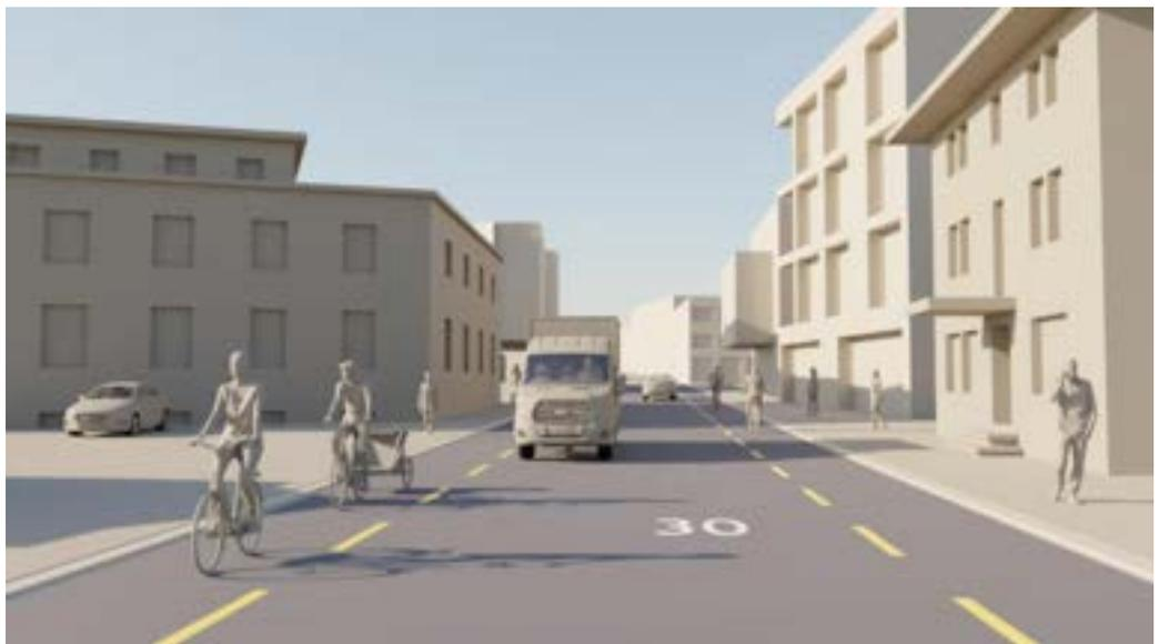
Abbildung 37: Führung auf Velostreifen bei erhöhtem DTV (> 5'000 Fzg./d) in Tempo 30
