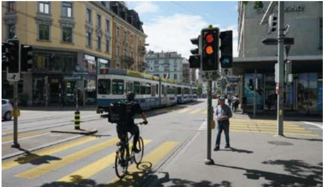
Abbildung 47: Optimierung der Velophasen durch eigenen Signalgeber
