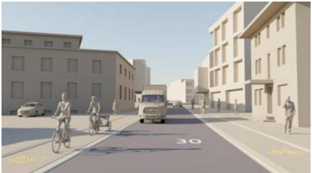
Abbildung 39: Führung auf separatem Veloweg bei erhöhtem DTV (> 5'000 Fzg./d) in Tempo 30
